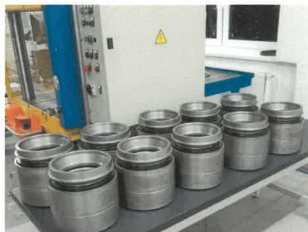
Nové technologie na hale č. 32 zahrnují i zařízení pro nedestruktivní zkoušení komponent nápravových ložisek. Kvalita povrchu válečků a kuželíků, přítomnost vad ve formě trhlin, spálenin a podobně, je kontrolována v robotickém pracovišti na automatizovaném zařízení pomocí vířivých proudů.
